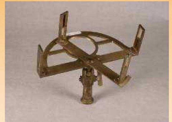
Alidade montée sur un graphomètre
